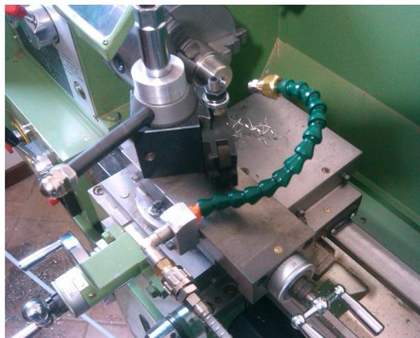
I Kit sono pronti al montaggio. Le staffe prevedono un fissaggio a vite per foro filettato M5.
